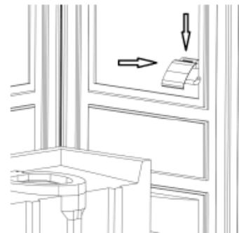
3.13. На внутренней стороне передней лицевой панели, просверлить отверстия для закрепления задвижки и крючка для одежды. Заклепать крючок и задвижку лепестковыми заклепками (4,8x21 мм):
