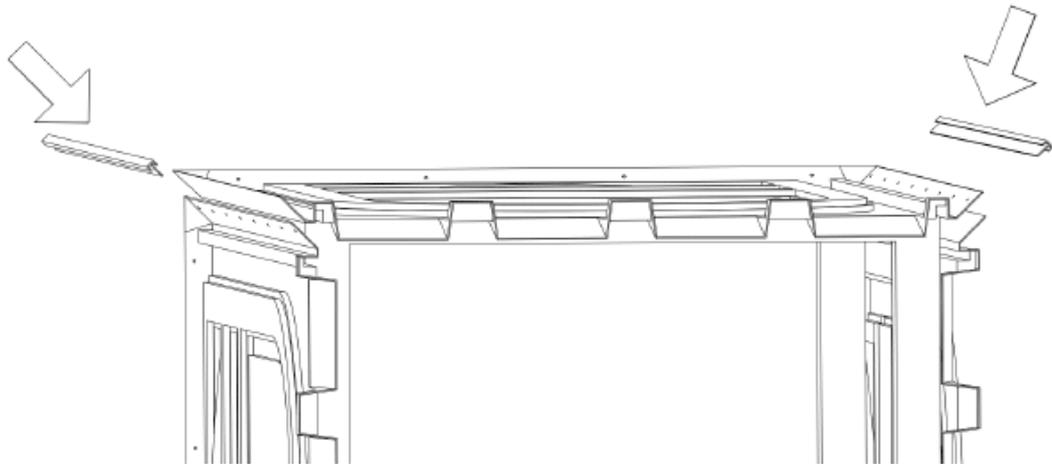
3.3. Выровнять Ш-профиль по нижней части боковой панели согласно эскизу. Ш-профиль не должен иметь изгибов:
