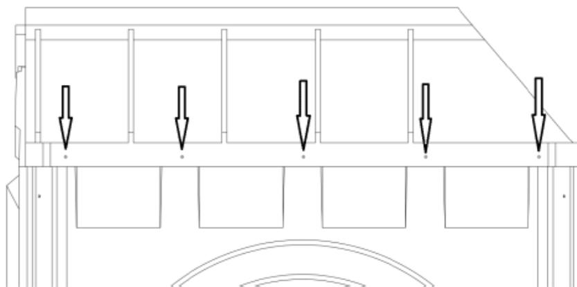
3.21. Просверлить отверстия в двери и закрепить лепестковыми заклепками (4,8x21 мм) проушину для замка. Вторую проушину закрепить таким же образом на арке:
