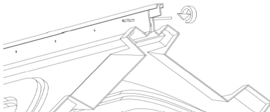
3.5. В просверленное отверстие вставить вытяжную заклепку (4,8x18мм), одеть шайбу и заклепать\*:
