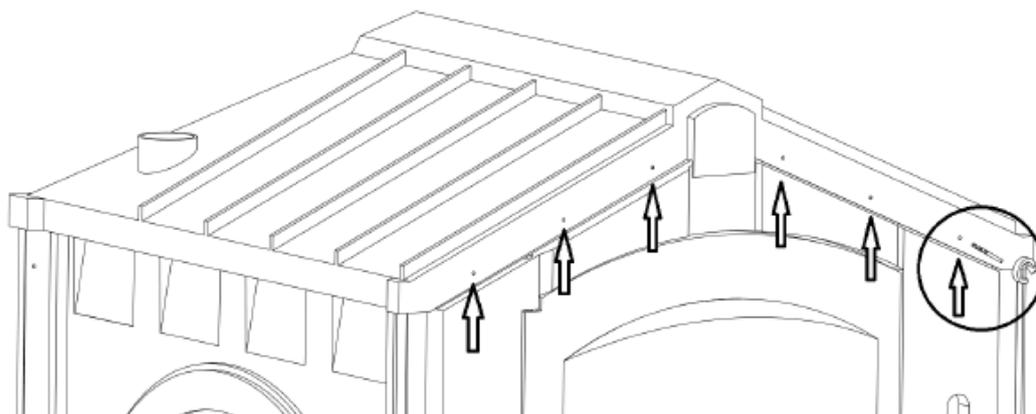
3.20. Просверлить 15 отверстий в крыше и трех боковых панелях (по 5 отверстий на каждую сторону), ориентируясь на специальные ребра жесткости, и закрепить вытяжными заклепками (4,8x18 мм) с шайбой:
