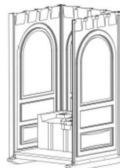
3.10. Для закрепления бака в четырех местах, просверлить отверстие в боковой панели вместе с баком и заклепать лепестковой заклепкой (4,8x21 мм).
